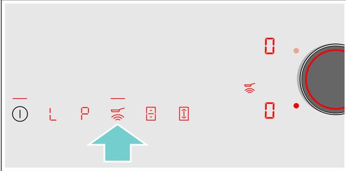
2. В течение следующих 5 секунд выберите требуемый температурный режим магнитным переключателем.
